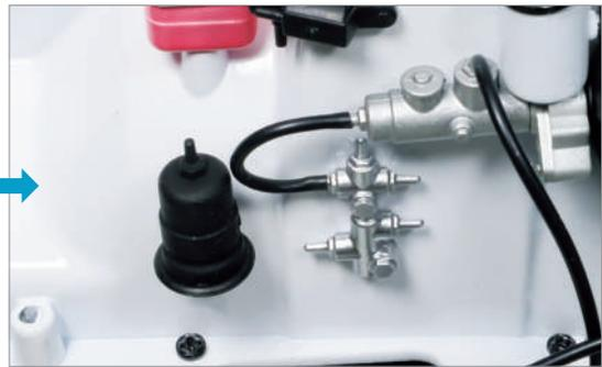
將在第 1 步中剪下的前輪煞車管 No.1 37-I 插入煞車主缸 35-I 的突起部分和前輪煞車管連接器 36-D 的左側突起部分。
