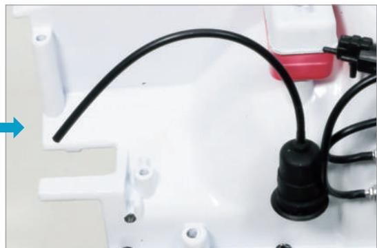
將在第 1 步中剪下的燃油管 37-J 插入 37-E 的突起部分。
