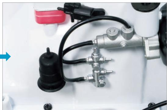
將在第 35 期安裝完成的後輪煞車管 No.1 35-M 插入比例閥 36-C 左側的突起部分。
