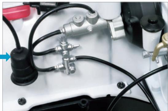
將在第 28 期安裝完成的底盤背面的後煞車軟管 No.3 24-H 插入到 36-C 的右側突起部分。
